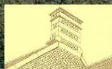
Souche de cheminée en pierre de taille
